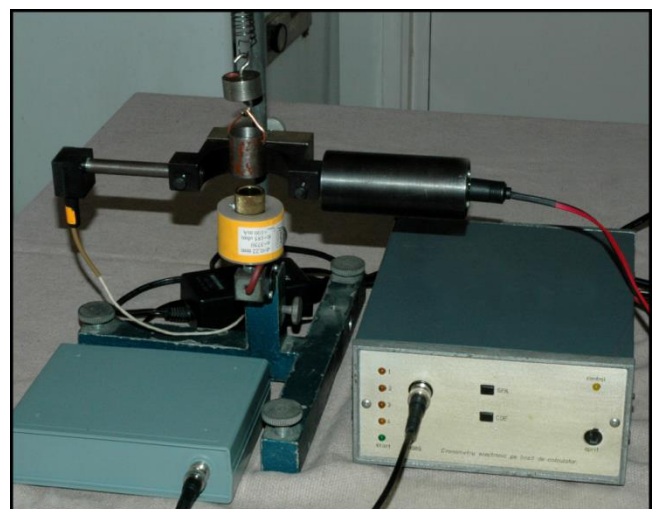
9. ábra. A megfogó elektromágnest és a fénysorompó. A sárgaréz anyja biztosítja az állandó nehezék és az elektromágnest közvetlen érintkezésének a megszünte-tését, a remanencia hatásának lényeges csökkentését.
