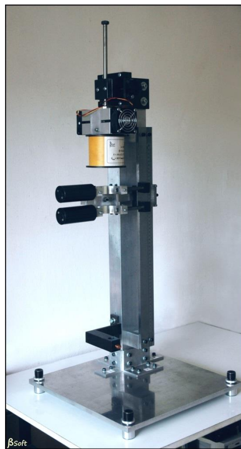
10. ábra. Félkész mini-szabadesés készülék. Kiegészítésként az oszlop aljára szerelt L formájú tartóba kerül az elektromágnes. A rugó megnyúlását század mm-es pontossággal lehet megmérni.
